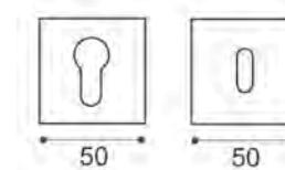
L'écusson est l'élément architectural qui entoure le trou ou le cylindre de la serrure. Il aide à protéger le cylindre contre les bris et à protéger la zone environnante contre les dommages et l'usure qui pourraient être causés par la clé. Les écussons sont disponibles dans une gamme de formes et de finis pour correspondre au modèle de poignée sélectionné.
